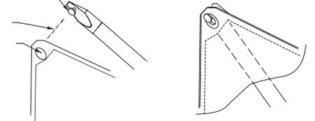
PULL THE FABRIC GRAPHIC TIGHT AND CONNECT GROMMET TO THUMB SCREW
